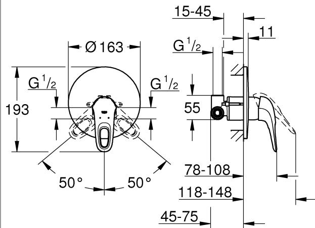
Bei der Installation von Unterputzbatterien mit Wannenfüll- und Überlaufgarnituren ist zu beachten, dass eine Sicherungseinrichtung zur Verhütung von Trinkwasserverunreinigungen durch Rückfließen montiert werden muss.
