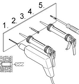
Skrufvälvningar i vätzon 1 ska göras i betong eller annan massiv konstruktion, träreglar, träkortlingar eller i konstruktion som är provad och godkänd för infästning, till exempel skivkonstruktion. Se exempel på godkända konstruktioner på säkervatten.se. Skruvfästningar i vätzon 1 får inte göras enbart i golv- eller väggskiva.
