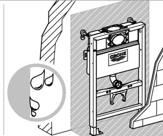
Skruvinfästningar i vätzon 1 ska göras i betong eller annan massiv konstruktion, träreglar, träkortlingar eller i konstruktion som är provad och godkänd för infästning, till exempel skivkonstruktion. Se exempel på godkända konstruktioner på säkervatten.se. Skruvfästningar i vätzon 1 får inte göras enbart i golv- eller väggskiva.
