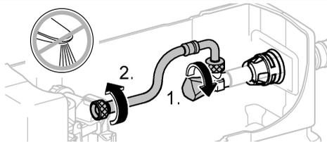
Skyddsror med YD 25mm ska användas tillsammans med medlevererad genomföring/tätning. Mediaröret ansluts mot R15 (1/2") utvärdig gänga med koppling enligt mediarörets monteringsanvisning. CE godkända mediarör i Ø12/Ø16mm med skyddsror YD 25mm kan användas. Dimension tillkoppling avstängnings-ventil: R15 (1/2") utvärdig rörgänga. Täthetskontroll av röranslutningarna ska utföras efter installationen.
