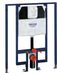
38 995 000 Rapid SL für Wand-WC für schmale Bäder Spülkasten 80 mm Elementbreite variabel, 0,7 – 1,2 m 1,13 m Bauhöhe 555,20
