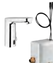
36 386 001 Infrarot-Elektronik für Waschtisch mit Mischung und variabel einstellbarem Temperaturbegrenzer inkl. Powerbox 899,35
