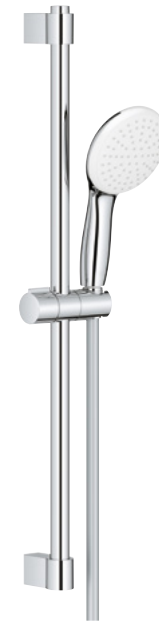
27924003 | 8233320 Tempesta 110 • 600 mm duschstång • 110 mm duschhuvud • 1 stråltyp (Rain) • Kombineras med termostater 34 843 000 eller 34 794 000 • Flöde (3 bar) 8,7 l/min
