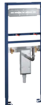
38 625 001 Rapid SL handikapp för tvättställ för installation med ett hål eller väggmonterade fästen, med dolt vattenlås justerbar utloppsböj i mässing krompläterad 1,13 m installationshöjd
