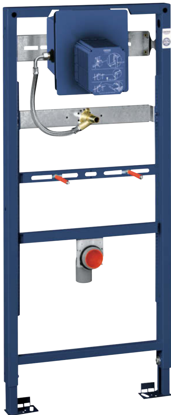
38 786 001 Rapid SL för urinoar med GROHE Rapido U för manuell spolning eller infraröd elektronik 6 V eller 230 V 1,13 m och 1,30 m installationshöjd
