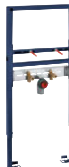
39 052 000 Rapid SL för tvättställ justerbar höjd, för installation med ett hål, 1,13 m installationshöjd, för installationer på väggar eller regelväggar, 2 ljuddämpade anslutningskopplingar ½ tum
