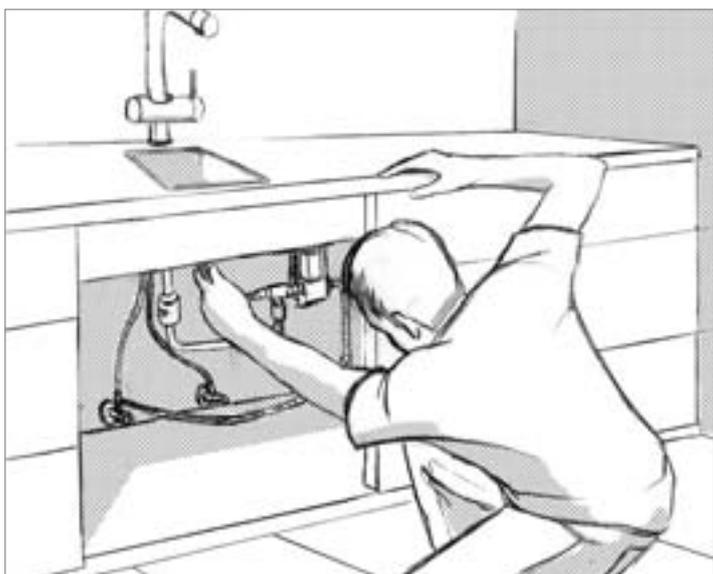
3. Подсоедините устройство к трубам горячего и холодного водоснабжения, как обычно. Теперь установите блок управления функцией EasyTouch, питающийся от батарей, между смесителем и местом подключения к холодной воде. Все готово!
