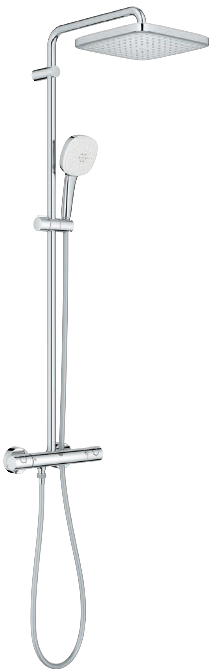
26 689 001 Tempesta Cosmopolitan 250 Cube System prysznicowy z baterią termostatyczną, słuchawka: 2 strumienie, obrotowe ramię 390 mm
