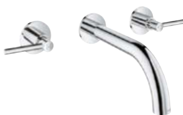
20 169 003 / DC3 / AL3 Trzyotworowa bateria umywalkowa montaż ścienny do montażu z 29 025 000 (zamawiany osobno) wysięg wylewki 180 mm
