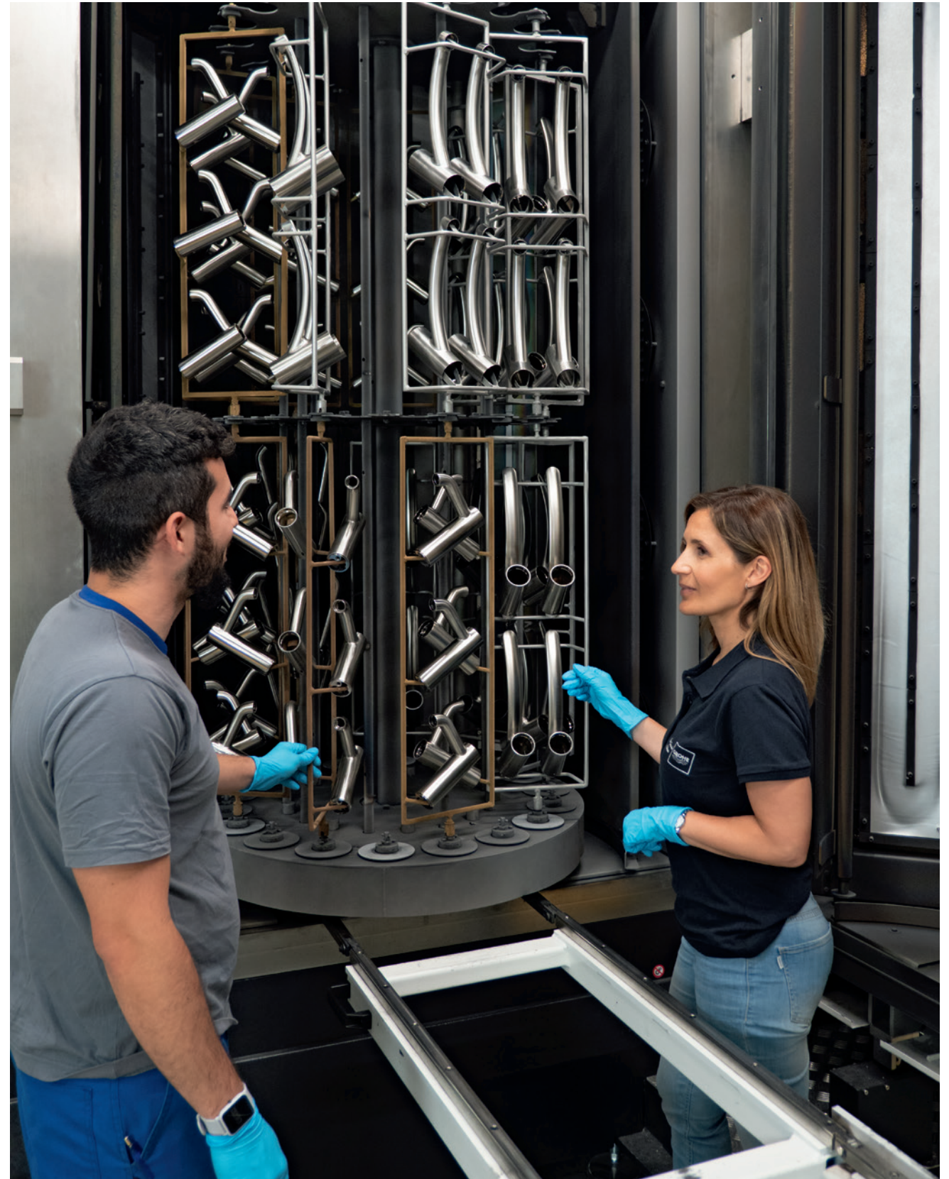
Cláudia Barbosa kieruje działem inżynierii przemysłowej w zakładzie GROHE w Albergarii w Portugalii. Mówi, że dzięki powłoce PVD armatura łazienkowa i kuchenna przetrwa lata użytkowania bez efektu blaknięcia.
