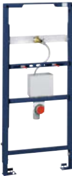
39 376 000 Rapid SL for urinal med inntakssett for T-sensor, 1,13 og 1,30 m installasjonshøyde, uten installasjonssett for T-sensorelektronikk (39 368 000 eller 39 369 000)
