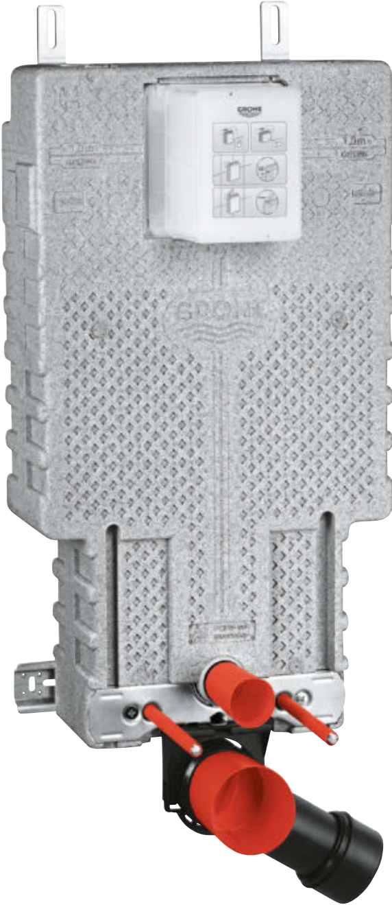
38 643 001 Uniset for toalett med sisterner 6 – 9 l dobbelspyling / start og stopp / enkelspyling, tilkobling fra venstre / høyre / bak eller topp for innbygging
