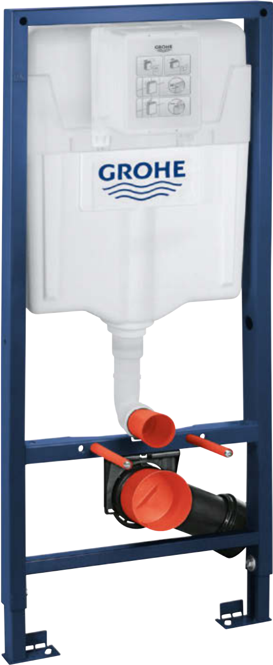
38 528 001 Rapid SL for toalett med sisterne 6 – 9 l dobbelspyling / start og stopp / enkelspyling tilkobling fra venstre / høyre / bak 1,13 m installasjonshøyde
