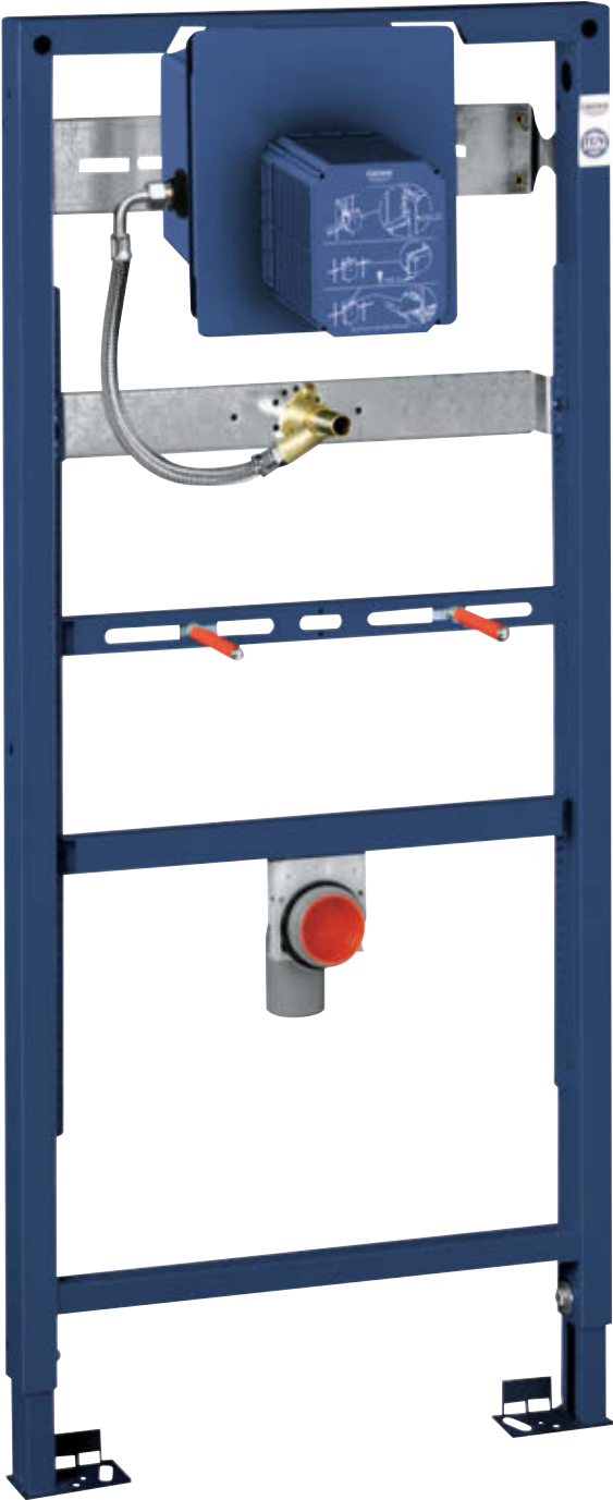
38 786 001 Rapid SL for urinal med GROHE Rapido U for manuell aktivering eller infrarød elektronikk 6 V eller 230 V 1,13 m og 1,30 m installasjonshøyde
