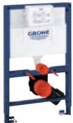
39 140 000 Rapid SL handicap for toalett sisterne GD 2 med liten vedlikeholdstilgang med festeelement for ryggstøtte og armstøtter, for toalettskål 70 cm fremspring 1,13 m installasjonshøyde
