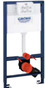
38 525 001 Rapid SL for toalett med sisterne 6 – 9 l dobbelspyling / start og stopp / enkelspyling tilkobling fra venstre / høyre / bak aktivering fra front / over 1,00 m installasjonshøyde
