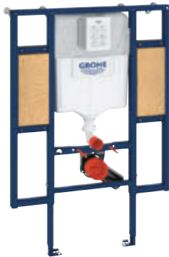
39 140 000 Rapid SL handicap for toalett sisterne GD 2 med liten vedlikeholdstilgang med festeelement for ryggstøtte og armstøtter, for toalettskål 70 cm fremspring 1,13 m installasjonshøyde
