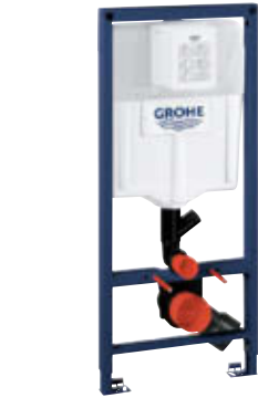
39 002 000 Rapid SL for toalett sisterne GD 2, med spylør, for ekstern luktfjerning med liten vedlikeholdstilgang 1,13 m installasjonshøyde
