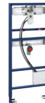
38 748 002 Inclusief ruwbouwset voor infrarood elektronische Europlus E 36042SD0, Essence E 36447000 en Eurocube E 36442000 voor installatie met voorgemengd of koud water zonder wandbevestigingsset 1,13 m installatiehoogte toepassing: voor wand- of systeemwandmontage
