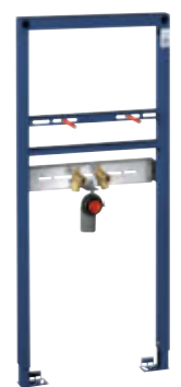
38 625 001 Rapid SL handicap voor wastafels met een eengatskraan of aan de muur gemonteerde kraan, met een ingebouwde sifon verstelbare metalen afvoerbocht verchroomd 1,13 m installatiehoogte
