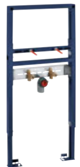
39 052 000 Rapid SL voor wastafels in hoogte verstelbaar, voor eengatsinstallatie, 1,13 m montagehoogte, voor installaties aan de muur of in systeemwanden, 2 geluidsisolerende kraanaansluitingen 1/2"
