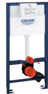
38 994 000 Rapid SL voor wc's voor kleine, smalle ruimten spoelreservoir 80 mm toegang tot reservoir via inspectieschacht 1,13 m installatiehoogte breedte element 0,62 m
