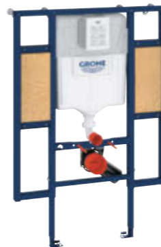
39 112 001 Rapid SL voor badkamer-wc's spoelreservoir GD 2 toegang tot reservoir via inspectieschacht 1,13 m montagehoogte, leiding voor GROHE Sensia watertoevoer, aansluiting voor netvoeding
