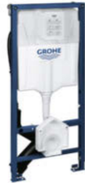
39 112 001 Rapid SL voor badkamer-wc's spoelreservoir GD 2 toegang tot reservoir via inspectieschacht 1,13 m montagehoogte, leiding voor GROHE Sensia watertoevoer, aansluiting voor netvoeding
