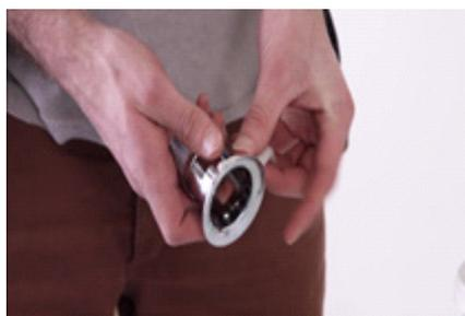
Positionnez le joint au dessus du vidage. Maintenez la bonde et vissez le vidage sur la partie filetée de la bonde en veillant à orienter l'axe de vidage vers l'arrière. Pour éviter toute fuite, vérifiez le serrage.
