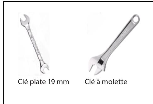
Vérifiez la présence de joint dans les flexibles. Au besoin, ajoutez un joint fibre ou caoutchouc. Vissez le flexible gauche sur le robinet d'eau chaude et le droit sur le robinet d'eau froide, serrez avec une clef plate de 19 mm. Vérifiez que les flexibles ne soient pas pliés ou tordus.
