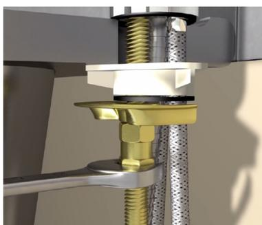
Tenez le robinet et à l'aide d'une clé plate de 17 mm, serrez l'écrou sans forcer.
