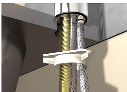
Insérez la bague de stabilisation par les flexibles puis le long de la tige filetée. De la même manière, insérez le joint de serrage et enfin, la cale de serrage. De vos doigts, vissez l'écrou au maximum.
