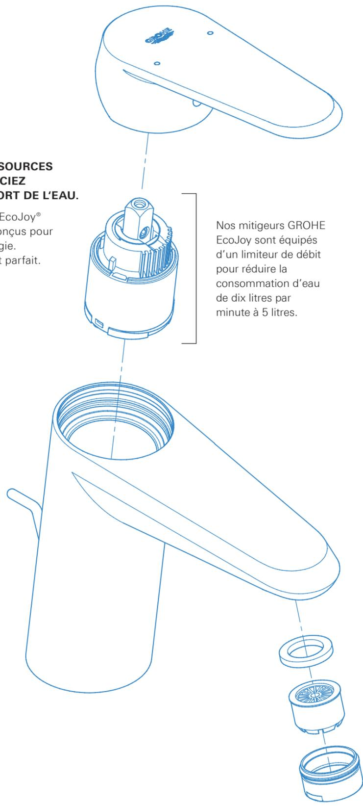
Nos mitigeurs GROHE EcoJoy sont équipés d'un limiteur de débit pour réduire la consommation d'eau de dix litres par minute à 5 litres.
