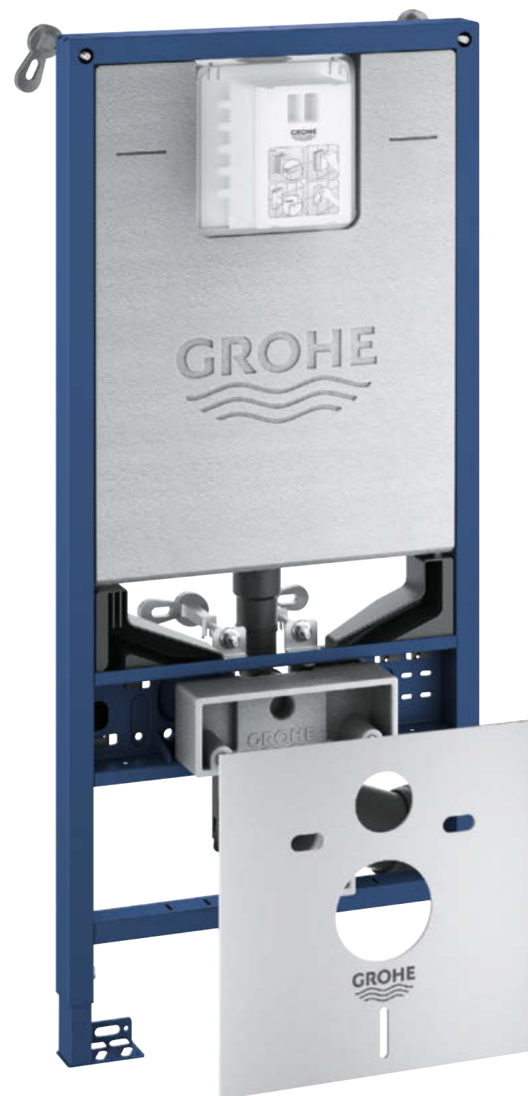
39 598 000 Rapid SLX 3 en 1 WC 6 | 1,13 m, avec équerres murales et protection anti-bruit Élément pour WC Rapid SLX, hauteur de montage à 1,13 m avec réservoir de chasse GD2, prise électrique, régulateur de débit inclus, accès facile et entièrement isolé contre la condensation. Avec équerres murales et protection anti-bruit.
