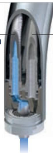
Para asegurarse de que el agua de GROHE Blue® no entra en contacto con el agua sin filtrar o con piezas de metal después de la filtración, la grifería de alta calidad incorpora dos conductos separados, uno para el agua potable de red y uno para el agua filtrada GROHE Blue®. Esto evita que su sabor pueda contaminarse.
