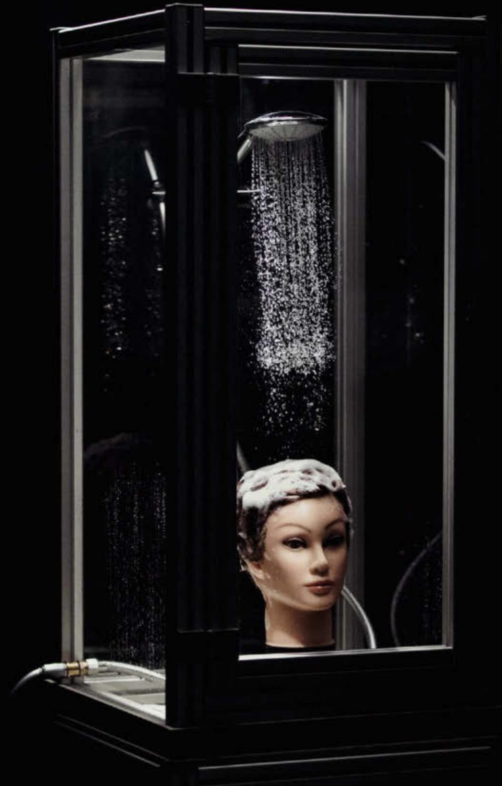
En el laboratorio de duchas de Bensing se prueban los cabezales de ducha para analizar cómo pueden optimizarse para ahorrar agua y mejorar su eficiencia.
