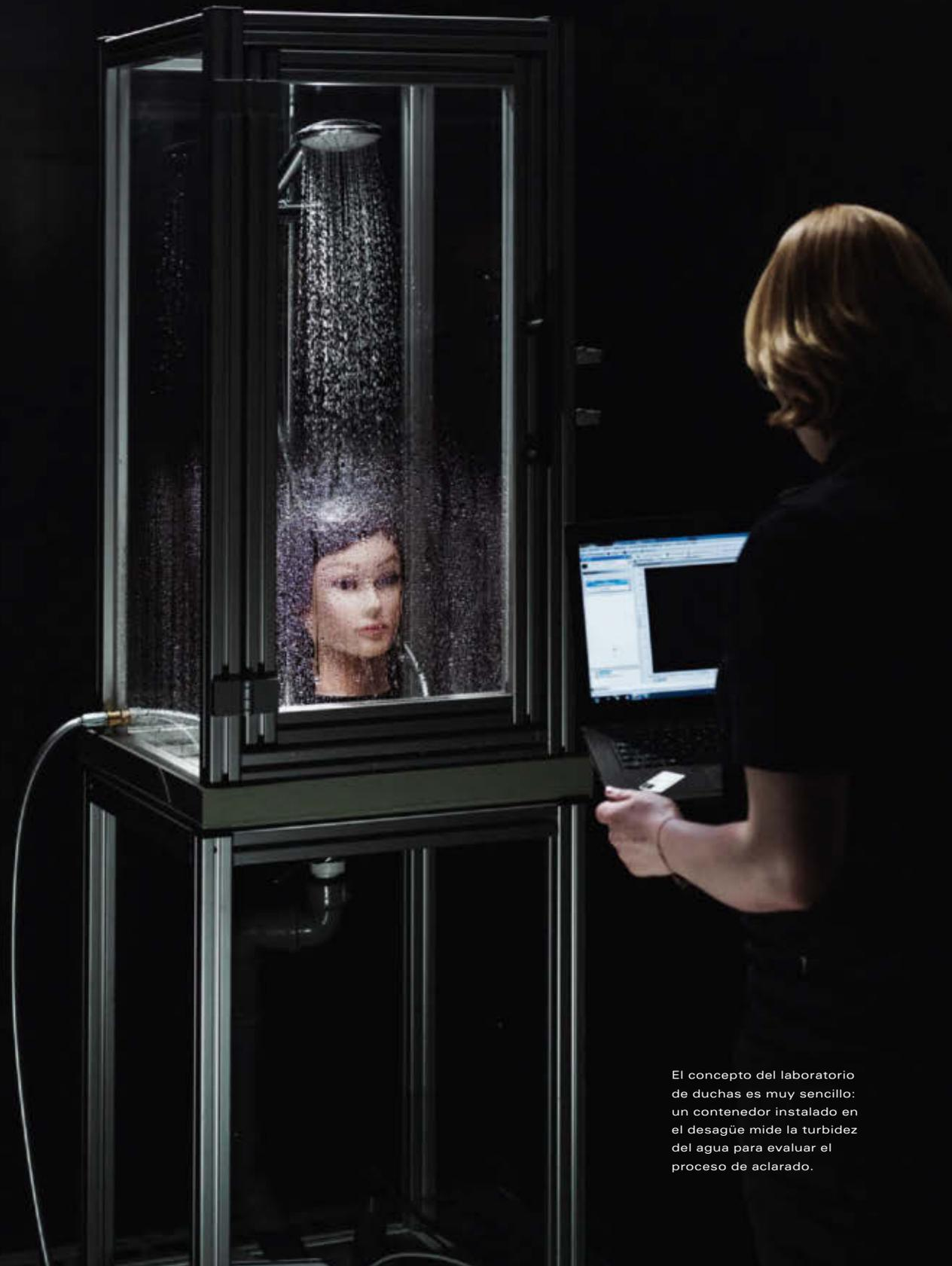
El concepto del laboratorio de duchas es muy sencillo: un contenedor instalado en el desagüe mide la turbidez del agua para evaluar el proceso de aclarado.
