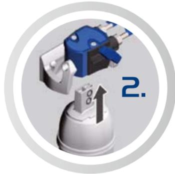
2. Es necesario retirar la cubierta protectora del nuevo filtro antes de insertarlo verticalmente en la cabeza del filtro.
