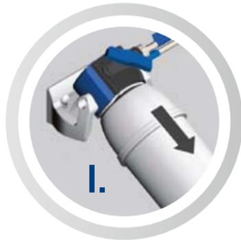
1. El filtro usado se extrae del cabezal tirando hacia abajo una vez desbloqueado el seguro de cierre.
