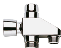
29 736 000 | 729347004 Omstilling | Brusertilslutning 1/2" | Tilslutningsomløber 1/2" | Udvendige gevind 1/2" og 3/4"
