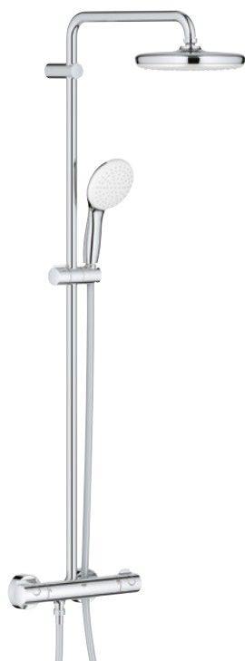
26 811 001 | 722278734 Tempesta System 210 | GROHE TurboStat tryk- og temperaturstyret termostat | 390 mm svingbar brusearm | 210 mm hovedbruser | 110 mm håndbruser med 1 stråletype | 8,3 l/min
