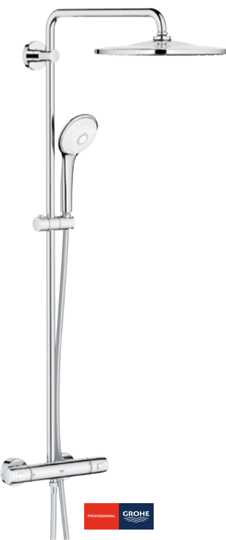
Euphoria 310 450 mm svingbar brusearm. 310 mm hovedbruser Tryk- og temperaturstyret termostat med aquadimmer funktion. GROHE CoolTouch, skoldningssikret Håndbruser med 3 stråletyper Justerbart beslag
