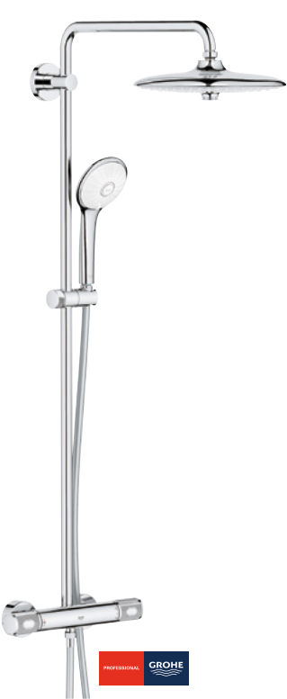
Euphoria 260 450 mm svingbar brusearm. 260 mm hovedbruser med 3 stråletyper. Tryk- og temperaturstyret termostat med aquadimmer funktion. GROHE CoolTouch, skoldningssikret. Håndbruser med 3 stråletyper. Justerbart beslag.
