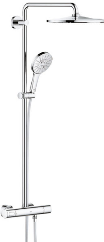
Rainshower 310 450 mm svingbar brusearm. 310 mm hovedbruser Tryk- og temperaturstyret termostat med aquadimmer funktion. GROHE CoolTouch, skoldningssikret Håndbruser med 3 stråletyper Justerbart beslag
