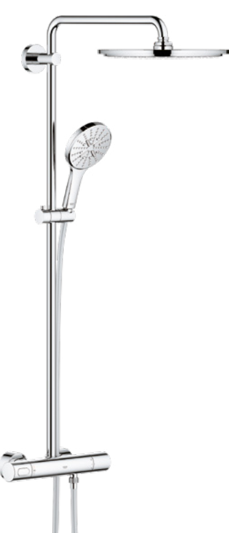
Rainshower SmartActive 310 450 mm svingbar brusearm. 310 mm hovedbruser. Tryk- og temperaturstyret termostat med aquadimmer funktion. GROHE CoolTouch, skoldningssikret. Håndbruser med 3 stråletyper. Justerbart beslag.
