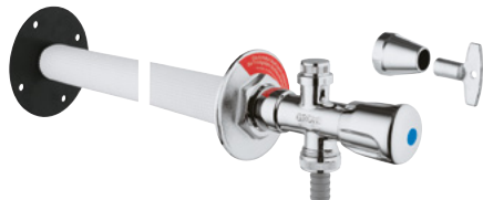
GROHE Eggemann Postthane til udvendig vægventil 1/2". Frostsikker. Indbygningsdybde 170-500 mm. Med kontraventil. GROHE nr.: 41 208 000 VVS nr.: 743420104
