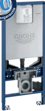
39 596 000 Rapid SLX für Wand-WC Spülkasten GD 2, 6 – 9 l, 2-Mengen-Betätigung, S-Size, werkseitige Einstellung 6 l und 3 l, mit Anschlüssen für Dusch-WCs Sensia IGS und Sensia Arena, 1,13 m Bauhöhe
