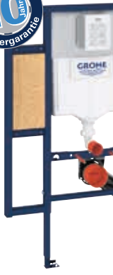
39 140 000 Rapid SL für Wand-WC Spülkasten GD 2, 6 – 9 l, 2-Mengen- oder Start- & Stopp- Betätigung, behindertengerechte Ausführung mit Befestigungsplatten für Rückenstützen und Haltegriffen, 1,13 m Bauhöhe
