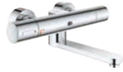
36 455 000 Eurosmart CE Spezial Infrarot-Elektronik für Waschtisch-Wand, mit Mischung und Thermostat, mit 6 V Lithium-Batterie, ungemischtes Warm- oder Kaltwasser in extremer Griffposition für Spülen, thermische Desinfektion oder Probenahme, Ausladung 255 mm 36 454 000 dito, Ausladung 287 mm
