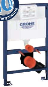
38 526 000 Rapid SL für Wand-WC Spülkasten 6 – 9 l, 2-Mengen- oder Start- & Stopp-Betätigung, werkseitige Einstellung 6 l und 3 l, Betätigung von oben/vorne, 0,82 m Bauhöhe
