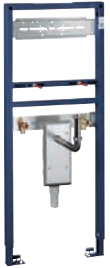
38 625 001 Rapid SL für Waschtisch mit UP-Geruchverschluss, mit Abdeckplatte für Geruchverschluss aus Edelstahl, mit verstellbarem Ablaufbogen aus Messing, 1,13 m Bauhöhe
