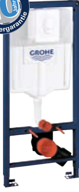
38 722 001 Rapid SL 3-in-1-Set für Wand-WC Spülkasten GD 2, 6 – 9 l, mit Betätigung Skate Air, alpinweiß, und Wandwinkel, werkseitige Einstellung 6 l und 3 l, 1,13 m Bauhöhe
