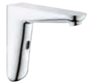
36 274 000 Euroeco CE Infrarot-Elektronik für Waschtisch-Wandarmatur, ohne Mischung, mit 6 V Lithium-Batterie
