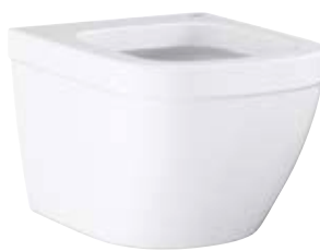
39 206 000 Euro Keramik Wand-Tiefspül-WC compact Ausladung 49 cm spülrandlos Triple-Vortex-Spülung Spülmenge 4,5/3l 39 206 00H mit Hygiene-Oberfläche
