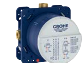
35 600 000 lieferbar ab Mai 2017 GROHE Rapido SmartBox 3 Abgänge 1/2" 2 Zuläufe unten, 1/2" Einbautiefe 75–105 mm
