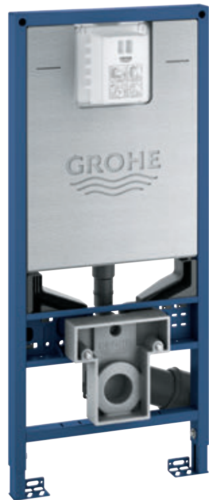
39 596 000 Rapid SLX Módulo WC, altura 1,13 m Montaje en tabique con montantes y/o delante de pared resistente Incluye Flow Manager
