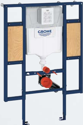
39 140 000 Rapid SL für Wand-WC – Barrierefrei-Spülkasten GD 2 mit Befestigungselement für Haltegriffe für WC-Becken mit bis zu 70 cm Ausladung 1,13 m Bauhöhe
