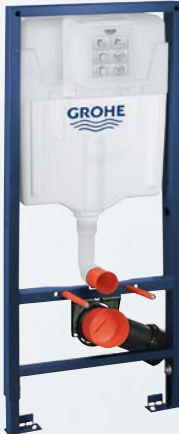
39 863 000 Rapid SL Element für WC, 1,13 m Bauhöhe Inkl. Spülstromdrossel
