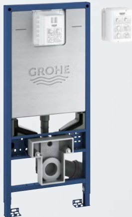
39 865 000 Rapid SLX Element für WC, 1,13 m Bauhöhe Inkl. Spülstromdrossel inkl. Stromanschluss (Klemmdose) und Wasseranschluss Für Dusch-WC inkl. großem und kleinem Revisionsschacht
