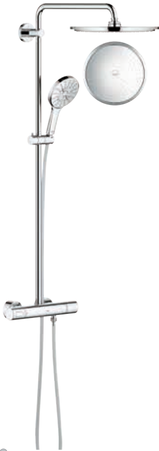
27 968 001 Rainshower 310 SmartActive Duschsystem QuickFix 100% CoolTouch Kopfbrause 310 Handbrause Ø 130 mm 3 Strahlarten: Rain, Jet, ActiveMassage mit 9,5 l/min. GROHE EcoJoy 27 966 001 ohne Durchflussbegrenzer
