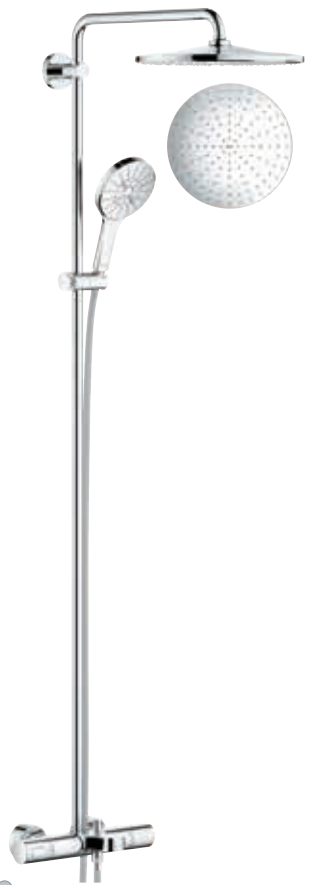
26 657 000 Rainshower 310 SmartActive Wannen- / Duschsystem QuickFix 100% CoolTouch Kopfbrause 310 Mono Handbrause Ø 130 mm 3 Strahlarten: Rain, Jet, ActiveMassage mit 9,5 l/min. GROHE EcoJoy
