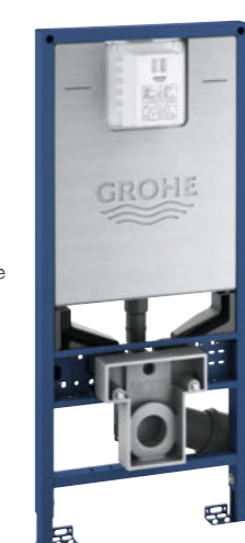
39 596 000 Rapid SLX für Dusch-WC, für 2-Mengen- oder Start- & Stopp- Betätigung, 1,13 m Bauhöhe, Spülkasten GD 2, 6–9 l, werkseitige Einstellung 6 l und 3 l, inkl. Stromanschluss (Klemmdose) und Wasseranschluss für Dusch-WC
