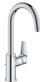
23 760 001 BauEdge L-Size Einhand-Waschtischbatterie mit 5,7 l/min. GROHE Water Saving, schwenkbarer Rohrauslauf, Zugstangen-Ablaufgarnitur aus Kunststoff 1 1/4"
