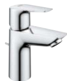
23 328 001 BauEdge S-Size Einhand-Waschtischbatterie mit 5,7 l/min. GROHE Water Saving, Zugstangen-Ablaufgarnitur aus Kunststoff 1 1/4"
