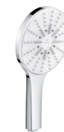
●●●●●●●●●○ GROHE SPA 101 676 0000 Rainshower Aqua Pure Handbrause mit 3 Strahlarten: GROHE Rain, Rain+, ActiveMassage, GROHE SmartTip Strahlumstellung per Tastendruck, GROHE DreamSpray, maximaler Durchfluss (bei 3 bar): 8,4 l/min.
