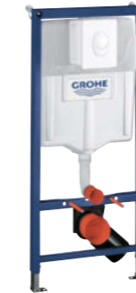
38 839 000 Rapid SL für Wand-WC für Vorwand- oder Ständerwandmontage für 2-Mengen- oder Start- & Stopp- Betätigung, 1,13 m Bauhöhe, Spülkasten GD 2, 6-9 l, werkseitige Einstellung 6 l und 3 l
