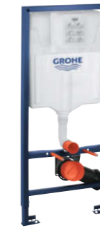
38 528 001 Rapid SL für Wand-WC, für 2-Mengen- oder Start- & Stopp- Betätigung, 1,13 m Bauhöhe, Spülkasten GD 2, 6–9 l, werkseitige Einstellung 6 l und 3 l
