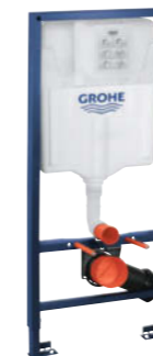
38 528 001 Rapid SL für Wand-WC, für 2-Mengen- oder Start- & Stopp- Betätigung, 1,13 m Bauhöhe, Spülkasten GD 2, 6-9 l, werkseitige Einstellung 6 l und 3 l
