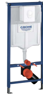
38 839 000 Rapid SL Projekt für Wand-WC für Vorwand- oder Ständerwandmontage für 2-Mengen- oder Start- & Stopp-Betätigung, 1,13 m Bauhöhe, Spülkasten GD 2, 6-9 l, werkseitige Einstellung 6 l und 3 l
