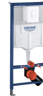
38 839 000 Rapid SL für Wand-WC für Vorwand- oder Ständerwandmontage für 2-Mengen- oder Start- & Stopp- Betätigung, 1,13 m Bauhöhe, Spülkasten GD 2, 6-9 l, werkseitige Einstellung 6 l und 3 l
