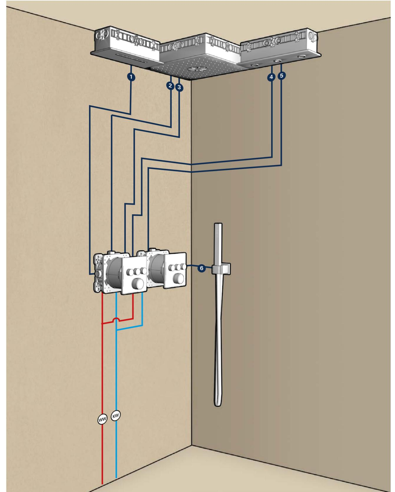
1 XL Wasserfall 2 PureRain Strahl 3 ActiveRain Strahl 4 Nebeldüsen 5 PureRain Strahl 6 Handbrause
