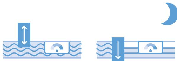
Один раз в сутки, ночью, когда обычно вода не используется, проводится расширенный тест на микроутечку. Для этого теста вода ненадолго перекрывается.
