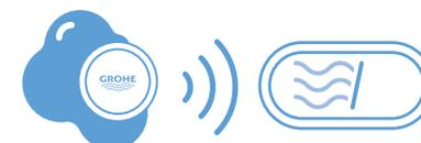
Если датчики GROHE Sense используются вместе с устройством GROHE Sense Guard, датчик GROHE Sense обнаружит затопление, а устройство GROHE Sense Guard автоматически перекроет воду.
