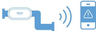
В этом случае на ваш мобильный телефон придет предупреждение, и, в зависимости от настроек, подача воды будет автоматически перекрыта для принятия дальнейших мер.
