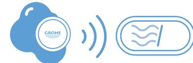
Wenn GROHE Sense-Sensoren zusammen mit GROHE Sense Guard verwendet werden und GROHE Sense eine Überflutung erkennt, unterbricht GROHE Sense Guard automatisch die Wasserversorgung.
