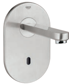
36 335 SD0 Infrarot-Waschtisch-Wandarmatur (230 V), ohne Mischeinrichtung Auslauf in Supersteel Rosette aus Edelstahl für UP-Einbaukasten 36 336 000 oder 36 337 000, Ausladung 172 mm 36 334 SD0 Ausladung 232 mm
