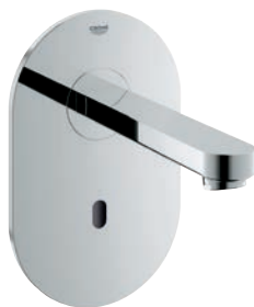
36 335 SD0 Infrarot-Waschtisch-Wandarmatur (230 V), ohne Mischeinrichtung Auslauf in Supersteel Rosette aus Edelstahl für UP-Einbaukasten 36 336 000 oder 36 337 000, Ausladung 172 mm 36 334 SD0 Ausladung 232 mm
