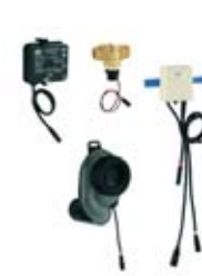
39 368 000 Temperatursensor für Urinal mit Trafo 100–240 V AC, 50–60 Hz, 6,75 V DC Siphon mit Temperatursensor 7 voreingestellte Programme – automatische Spülung – Reinigungsmodus Vorspülung CE-Zeichen
