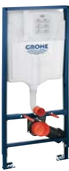
38 528 001 Rapid SL für WC mit Spülkasten GD2 Start/Stopp oder 2-Mengen (6 l / 3 l) Vorwand- oder Ständerwandmontage Bauhöhe 1,13 m
