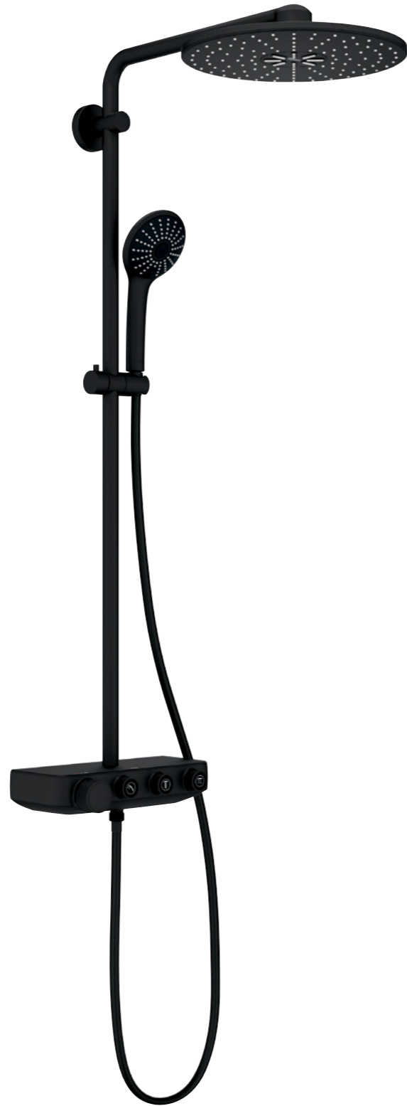
Euphoria SmartControl System 310 Duo Brusesystem med trykstyret SmartControl-termostat, 310 mm hovedbruser med 2 stråletyper og håndbruser med 3 stråletyper. GROHE nr.: 22 120 KF0 VVS nr.: 722680.821
