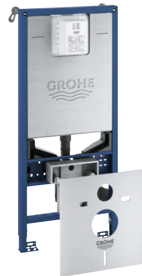
39 598 000 Rapid SLX 3in1 WC 6 | 1.13 m z uchwytemi ściennymi i matą wyciszającą Stelaż podtynkowy Rapid SLX, wysokość zabudowy ze zbiornikiem sflukującym GD2 1,13 m, przyłącze elektryczne, regulator przepływu wody, łatwy dostęp przyłącze elektryczne, przed kondensacją pary wodnej. Z uchwytemi ściennymi i matą wyciszającą.
