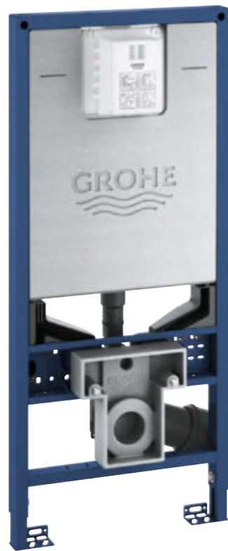
39 596 000 Rapid SLX WC 3-6 | 1,13 m, Standaard Rapid SLX-element voor wc's met een montagehoogte van 1,13 m, GD2-spoelreservoir, geïntegreerde 230 V aansluiting, flow manager, makkelijke toegang en volledige isolatie tegen condensvorming.
