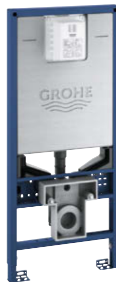
39 597 000 Rapid SLX WC 3-6 | 1.13 m, sans tuyau d'évacuation Élément pour WC Rapid SLX, hauteur de montage à 1,13 m avec réservoir de chasse GD2, prise électrique, régulateur de débit inclus, accès facile et entièrement isolé contre la condensation. Sans tuyau d'évacuation.
