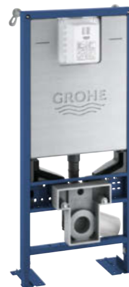
39 599 000 Rapid SLX WC 3-6 | 1.13 m F, avec pieds pour charges lourdes Élément pour WC Rapid SLX, hauteur de montage à 1,13 m avec réservoir de chasse GD2, prise électrique, régulateur de débit inclus, accès facile et entièrement isolé contre la condensation. Avec pieds pour charges lourdes.
