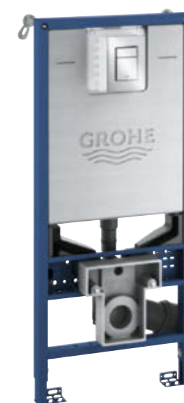
39 603 000 Rapid SLX WC 3-6 | 1.13 m, avec équerres murales, Skate Cosmopolitan S chrome Élément pour WC Rapid SLX, hauteur de montage à 1,13 m avec réservoir de chasse GD2, prise électrique, régulateur de débit inclus, accès facile et entièrement isolé contre la condensation. Avec équerres murales et plaque de commande coloris Skate Cosmopolitan S (chrome).
