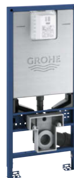
39 599 000 Rapid SLX WC 3-6 | 1.13 m F, avec pieds pour charges lourdes Élément pour WC Rapid SLX, hauteur de montage à 1,13 m avec réservoir de chasse GD2, prise électrique, régulateur de débit inclus, accès facile et entièrement isolé contre la condensation. Avec pieds pour charges lourdes.
