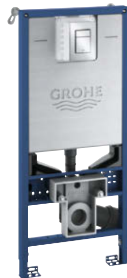
39 603 000 Rapid SLX für WC 3-6 | 1,13 m mit Zubehör für Vorwandmontage mit Abdeckplatte Skate Cosmopolitan S Rapid SLX Element für das WC, 1,13 m Montagehöhe mit Spülkasten GD2, mit Elektroanschlussbuchse, einschließlich Spül-Manager, Revisionsöffnung und vollständig isoliert gegen Kondenswasser. Mit Wandwinkeln und Betätigungsplatte Skate Cosmopolitan S (Chrom).
