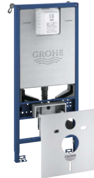
39 598 000 Rapid SLX 3 in 1 Set für WC 6 | 1,13 m mit Zubehör für Vorwandmontage mit WC-Schallschutzset Rapid SLX Element für das WC, 1,13 m Montagehöhe mit Spülkasten GD2, mit Elektroanschlussbuchse, einschließlich Spül-Manager, Revisionsöffnung und vollständig isoliert gegen Kondenswasser. Mit Wandwinkeln und Geräuschschutz.
