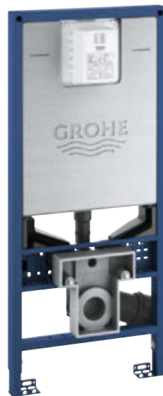
39 596 000 Rapid SLX für WC 3-6 | 1,13 m Rapid SLX Element für das WC, 1,13 m Montagehöhe mit Spülkasten GD2, mit Elektroanschlussbuchse, einschließlich Spül-Manager, Revisionsöffnung und vollständig isoliert gegen Kondenswasser.
