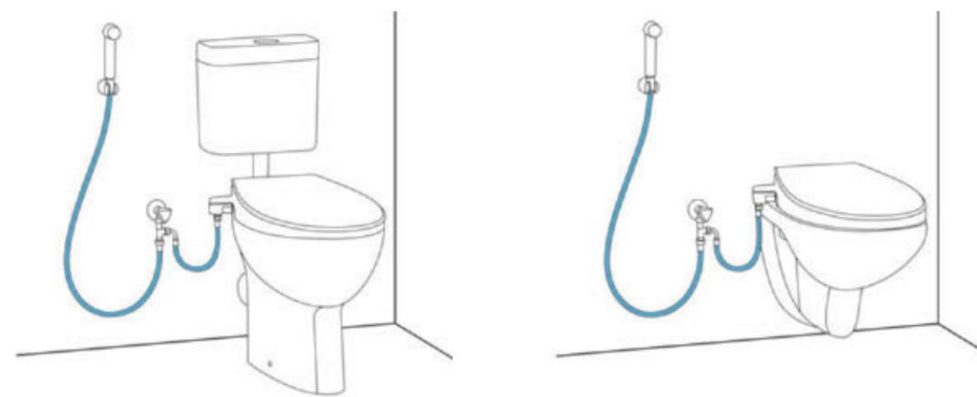
ПОДКЛЮЧЕНИЕ К ТОЧКЕ ПОДВОДА ВОДЫ ВНУТРИ БАЧКА УНИТАЗА
