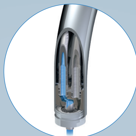
Oddělené vnitřní rozvody pro nefiltrovanou a filtrovanou pitnou vodu.
