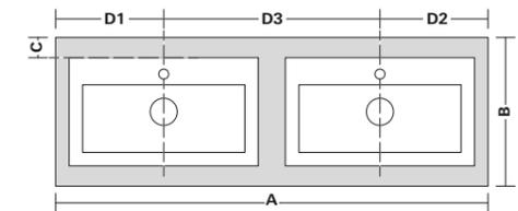
**D1** Randabstand links bis Abflussmitte Becken: ..... mm **D3** Mittelabstand Becken: ..... mm
