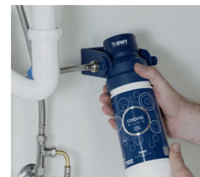
Attachez le support du filtre au meuble et vissez le filtre sur la tête du filtre. Ensuite, raccordez le filtre à l'alimentation en eau froide.
