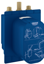
36 459 000 Inbouwelement voor douche met transformator 100 – 240 V AC en geïntegreerde thermostaatmengkraan geschikt voor infraroodset 36 456 000
