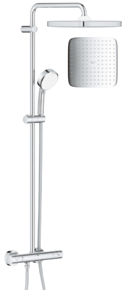
26 689 000 Tempesta Cosmopolitan 250 Cube Душевая система с термостатом: Верхний душ Tempesta 250 мм, режим струи Rain, EcoJoy 9.5 л/мин, Поворотный кронштейн 390 мм, Ручной душ Ø 100 мм, 2 режима струи, EcoJoy 5.7 л/мин
