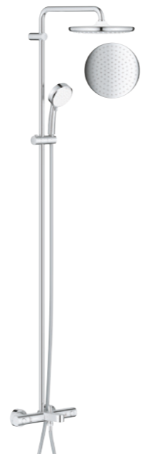
26 672 000 Tempesta Cosmopolitan 250 Cube Душевая система с термостатом для ванны: Верхний душ Tempesta Ø 250 мм, режим струи Rain, EcoJoy 9.5 л/мин, Поворотный кронштейн 390 мм, Ручной душ Ø 100 мм, 2 режима струи, EcoJoy 5.7 л/мин излив для ванны
