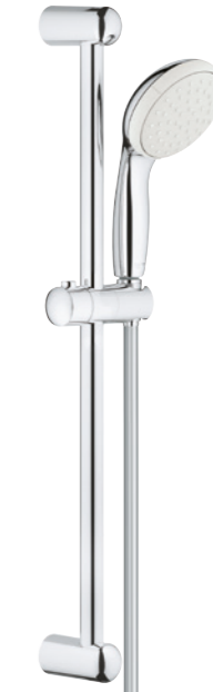
27 853 001 Tempesta 100 Душевой гарнитур: Ручной душ 100 мм, режим струи Rain, Душевая штанга 600 мм 27 924 001 Вариант с ограничителем потока GROHE EcoJoy 9.5 л/мин
