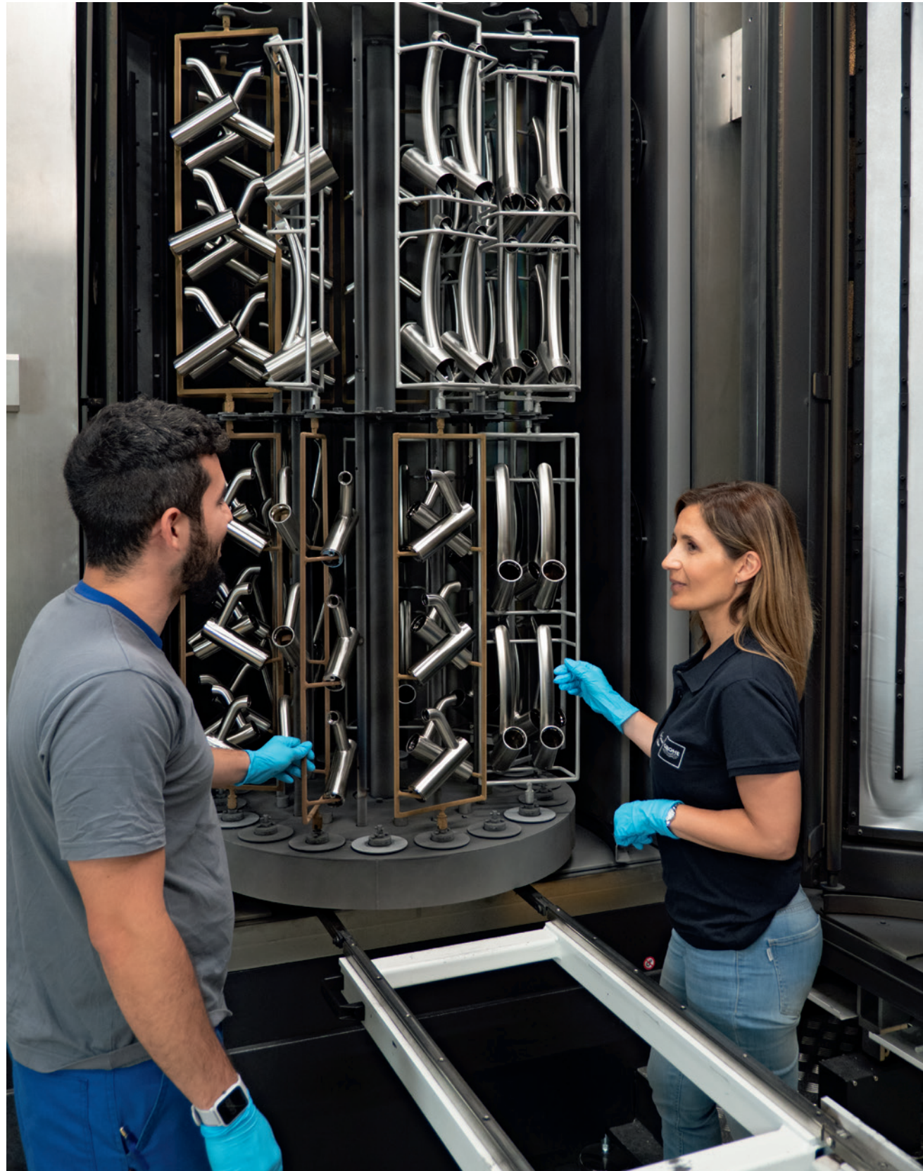
تترأس كلوديا باربوسا الهندسة الصناعية في مصنع GROHE في ألبرجاريا، البرتغال. وتقول إنه مع طلاء PVD، ستستمر تجهيزات الحمامات والمطبخ سنوات من الاستخدام دون أن تتلاشى.
