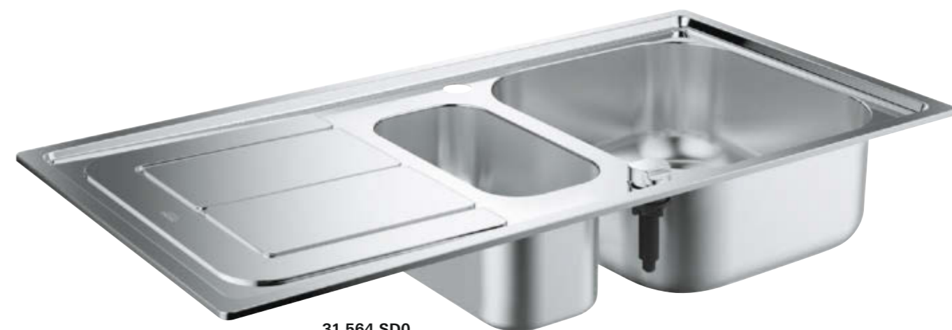
31 564 SD0 K300 Lavello in acciaio inox con gocciolatoio tipologia di installazione: incasso standard base: 600 mm dimensioni: 970 x 500 mm 1 vasca: 360 x 400 x 175 mm 0.5 vasca: 150 x 300 x 155 mm reversibile foro incasso: 950 x 480 mm 2 fori per miscelatore e comando remoto della piletta automatica
