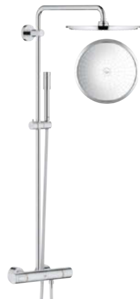
27 966 000 Rainshower System 310 Sistema doccia con miscelatore termostatico Soffione doccia Rainshower da 310 mm Braccio soffione sporgenza 450 mm Manopola doccia Sena Sistema anticottatura 100 % GROHE CoolTouch Elemento termostatico GROHE TurboStat
