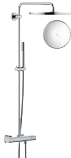
27 174 001 Rainshower System 400 Sistema doccia con miscelatore termostatico Soffione doccia Rainshower da 400 mm Braccio soffione sporgenza 450 mm Manopola doccia Sena Sistema anticottatura 100 % GROHE CoolTouch Elemento termostatico GROHE TurboStat
