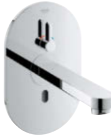
36 412 000 Robinetterie de lavabo infrarouge Eurosmart Cosmopolitan E (230 V) montage mural, avec mitigeur pour application, saillie : 172 mm pour caisson encastré 36 339 000
