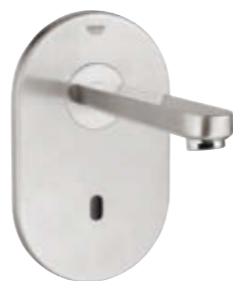
36 335 SDO Robinetterie de lavabo infrarouge (230 V) montage mural, saillie : 172 mm 36 334 SDO Bec en laiton SuperSteel rosace en acier inoxydable pour caisson encastré 36 336 000 ou 36 337 000, saillie : 232 mm
