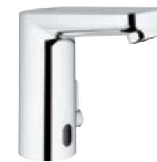
36 325 001 Robinetterie de lavabo infrarouge (230 V) avec mitigeur
