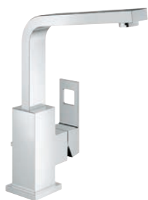
23 135 00E Taille L Mitigeur monocommande avec vidage Mousseur SpeedClean / Débit 5 l/min Hauteur totale 248 mm 23 135 000 Version sans débit limité
