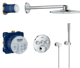
34 709 000 Set de douche encastré Douche de tête Rainshower 310 Douchette à main Euphoria Cube Mitigeur mécanique SmartControl 3 sortie À associer avec le corps encastré
