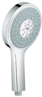
● ○ 27 664 000 / 27 663 LSO Douchette Ø 130 mm 4 jets : Rain, GROHE Rain O 2 , Massage et Jet GROHE EcoJoy - Débit régulé 8 l/min
