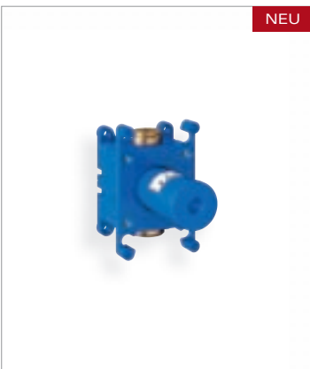
35 028 000 Rapido C Universal-Einbaubox Durchfluss: 55 l/min. bei 3 bar Einbautiefe 70 - 95 mm
