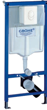
38 839 000 Rapid SL Projekt für WC mit Spülkasten GD 2 Start/Stopp oder 2-Mengen (6 l / 3 l) Vorwand oder Ständerwandmontage 1,13 m Bauhöhe
