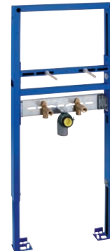
39 052 000 Rapid SL für Waschtisch höhenverstellbar für Einlochbatterie, 1,13 m Bauhöhe,
